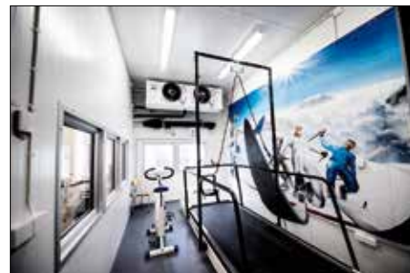
I rummet som är 21 m 2 kan temperatur och syrehalt kombineras men även motvind kan skapas med fläktar.
