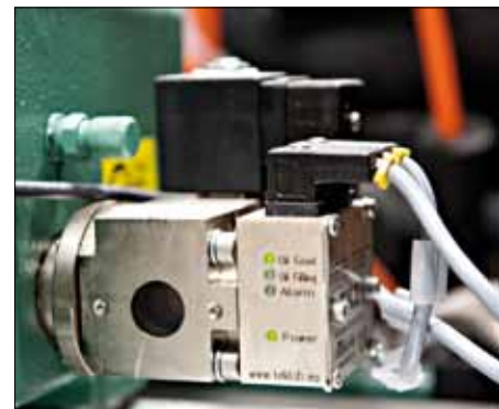
Avancerad övervakning av oljesystemet. Larmar direkt om oljenivån sjunker.
